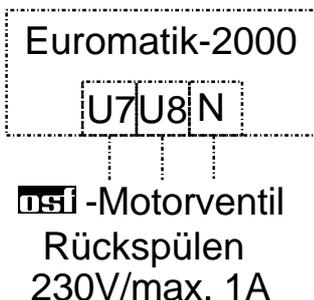
Wenn beim Rückspülen der Wasservorrat im Auffangbehälter nicht ausreicht besteht die Möglichkeit, das erforderliche Wasser aus dem Schwimmbad zu entnehmen. An die Klemmen U7 und U8 kann ein 2-Wege Motorventil angeschlossen werden, welches mit dem Bodenablauf verbunden wird. Während des Rückspül- und Klarspülvorgangs wird dieses Ventil aufgefahen, andernfalls ist es geschlossen. Der Kontakt ist mit 230V 1A belastbar. → Klemme U7 → auf, Klemme U8 zu
