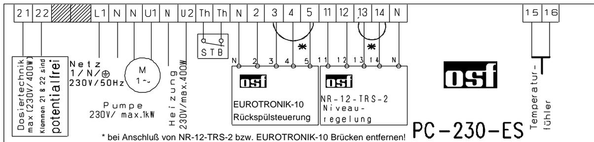
Die werksseitig eingefügte Brücke zwischen den beiden mit *Th* bezeichneten Klemmen muss bei Anschluss eines Sicherheits-Temperaturbegrenzers entfernt werden. Erfolgt kein Anschluss, dann muss sie eingeschraubt bleiben.
